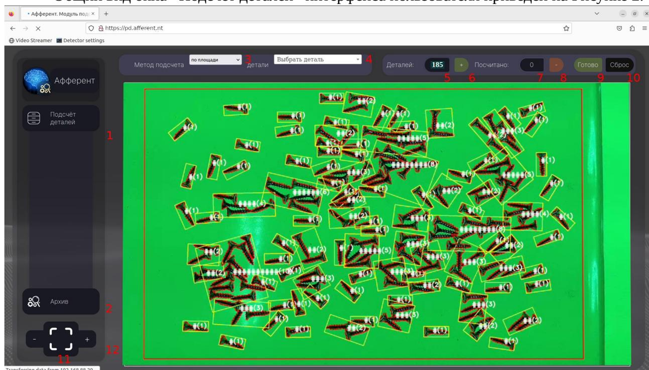
**Рисунок 2. Окно «Подсчет деталей» интерфейса пользователя**
